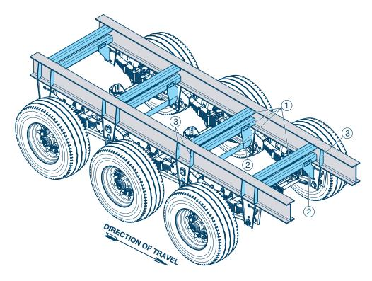
Fig.: ECO Cargo VB Tridem suspension
